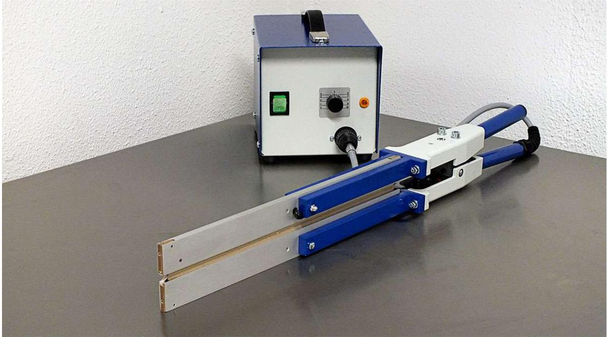
Diese Schweißzange hat eine Schweißlänge von 340 mm. Sie ist mit geraden Greifbacken ausgeführt und fungiert als Scherenmodell. Die Schweißzeit lässt sich auf dem dazugehörigen Impulsgeber stufenlos einstellen. Eine Anzeige zeigt die Schweißzeit auf der Schweißzange genau an und garantiert somit ein gutes und konstantes Schweißergebnis.
