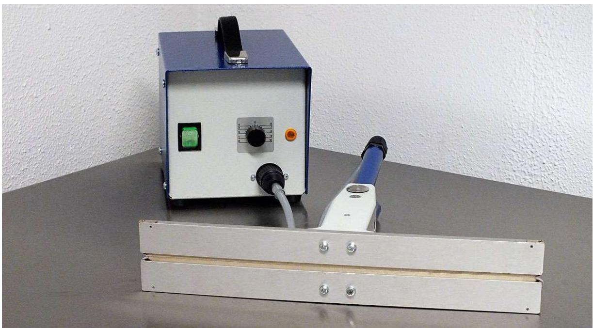
Diese Schweißzange hat eine Schweißlänge von 330 mm. Die Schweißzeit lässt sich auf dem dazugehörigen Impulsgeber stufenlos einstellen. Eine Anzeige zeigt die Schweißzeit auf der Schweißzange genau an und garantiert somit ein gutes und konstantes Schweißergebnis.
